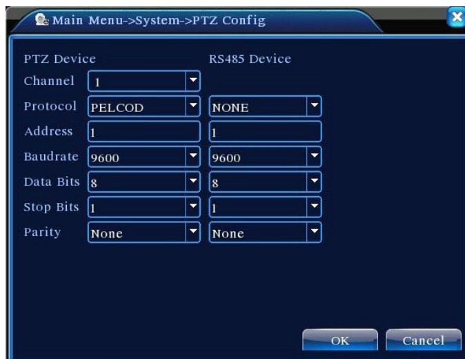
Рисунок 4.29. Установка поворотной камеры
